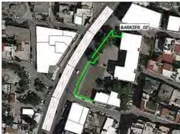
Σχήμα 7.2: Σενάριο 2 εφαρμογής αντιθορυβικού πετάσματος: ΔΙΑΜΟΡΦΩΣΗ ΕΙΣΟΔΟΥ ΕΠΙ ΤΗΣ ΛΕΩΦ. ΘΗΒΩΝ
