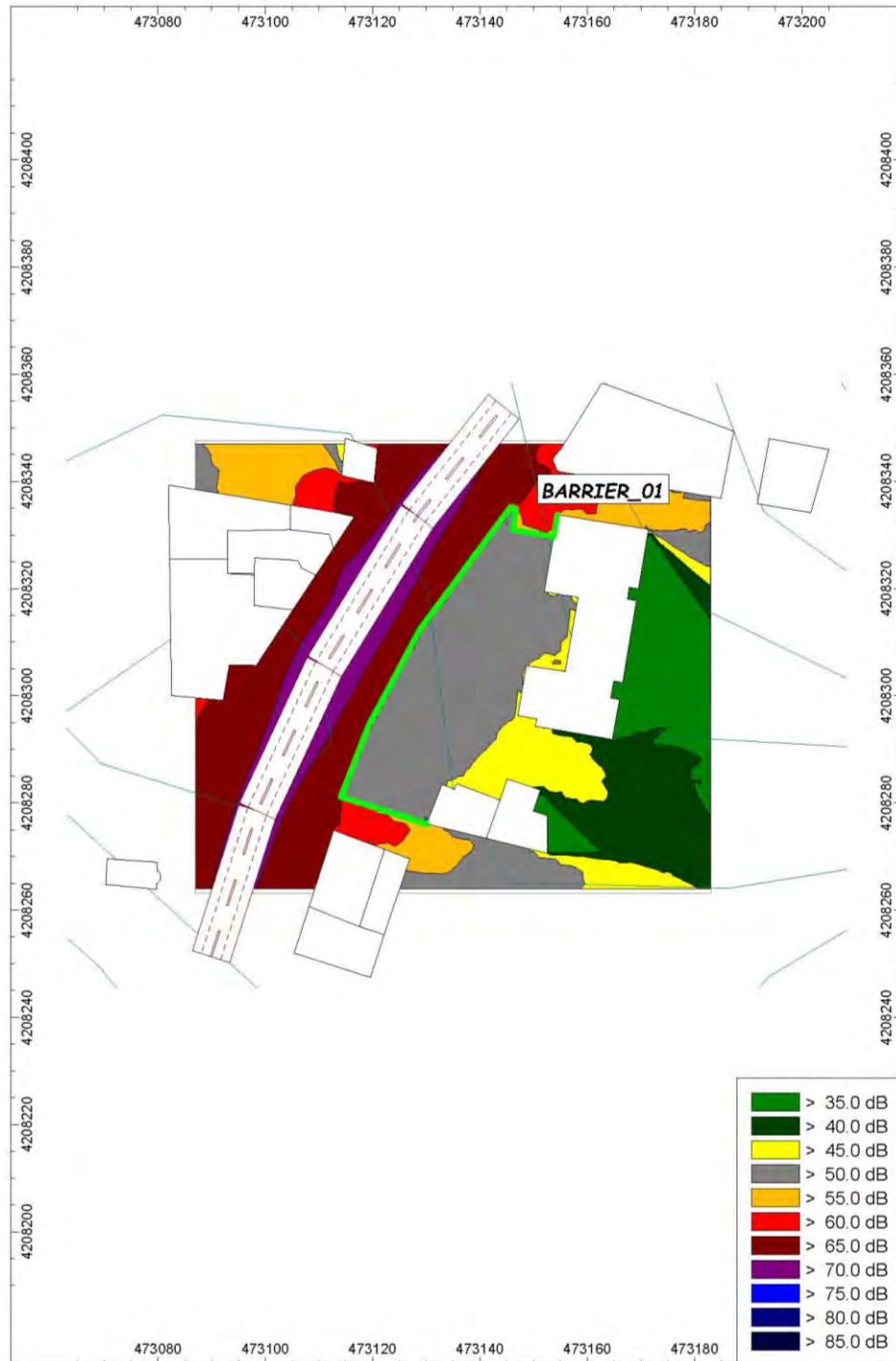
Σχήμα 7.14: Οριζόντιος χάρτης θορύβου. Έλεγχος σε ύψος h=4,0\mu - Δείκτης L_{night}
