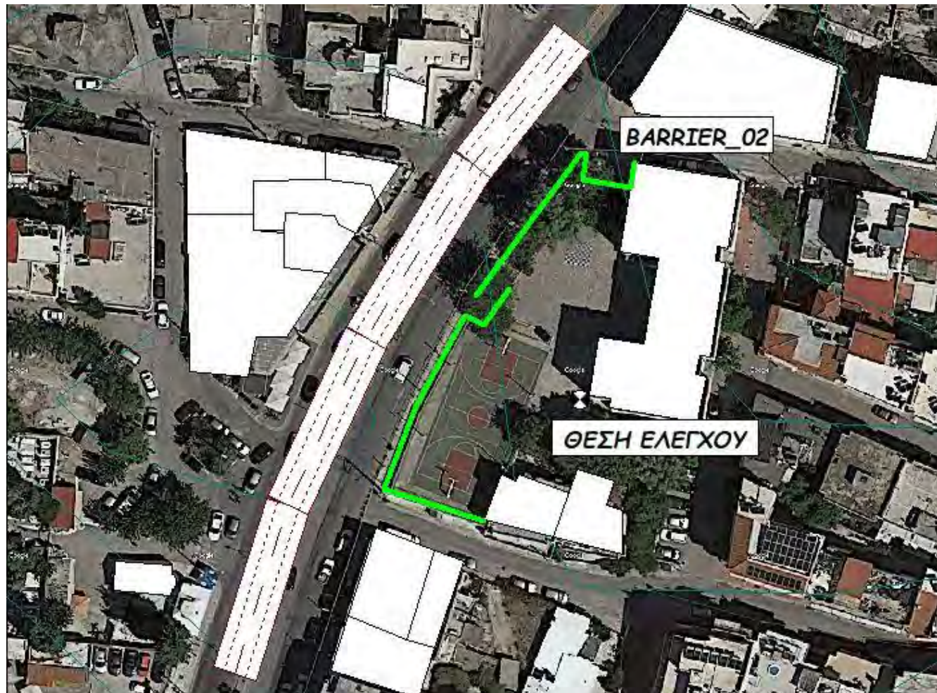
Σχήμα 7.18: Ψηφιακό υπόβαθρο (DTM) περιοχής μελέτης και θέσεις ελέγχου ειδικού λογισμικού CadnaA.
