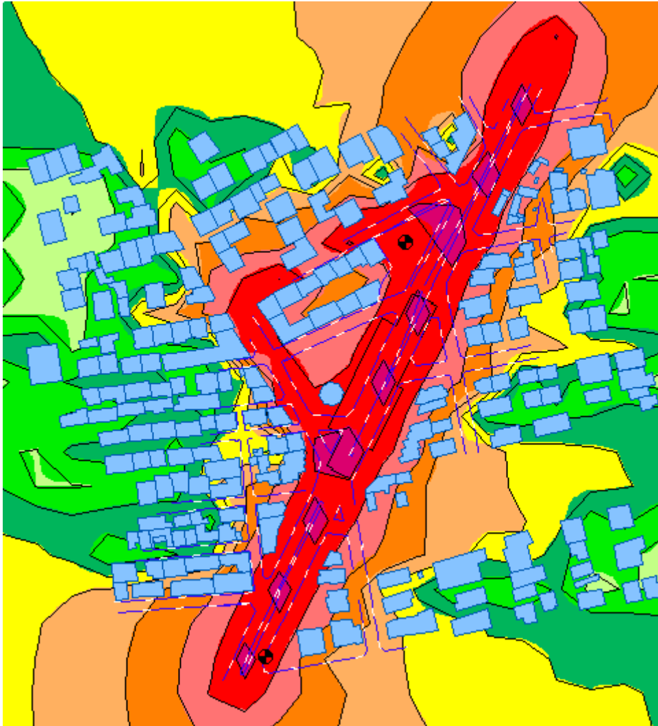
Εικόνα 9-26 Σταθμός Ίλιον – δείκτης Lnight – ΜΕ ΤΟ ΕΡΓΟ-2040
