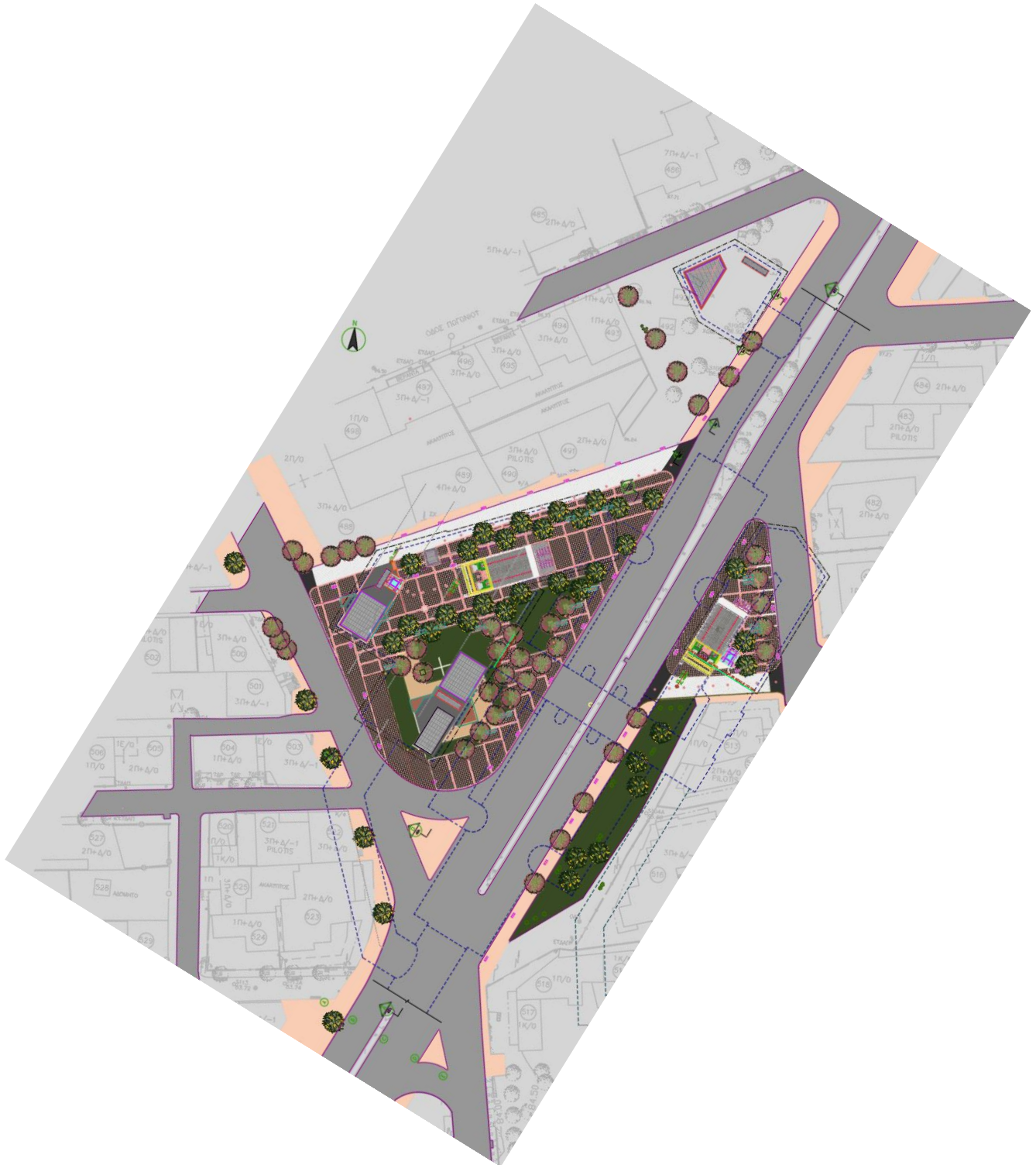
Εικόνα 8-16 Σταθμός Ίλιον (περί τη ΧΘ 5+000)- Τελική Διαμόρφωση στο επίπεδο της οδού
