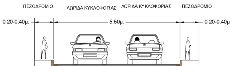
Εικόνα 1.14: Υφιστάμενη Κατάσταση οδού Βοσπόρου
