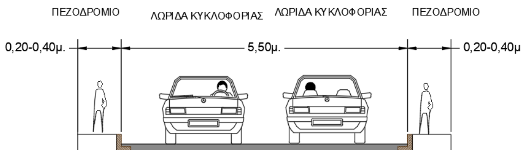
Εικόνα 1.12: Υφιστάμενη Κατάσταση οδού Κοραή
