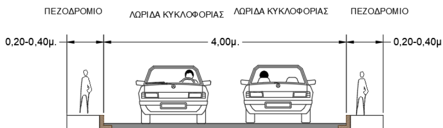
Εικόνα 1.16: Υφιστάμενη Κατάσταση οδού Βελισσαρίου
