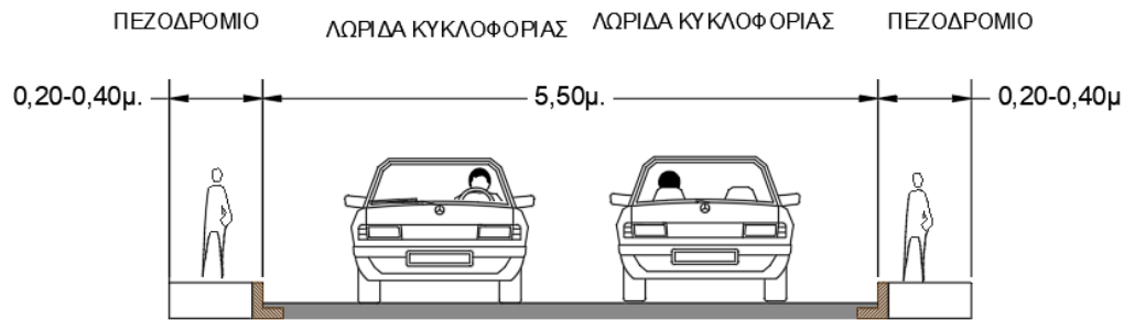
Εικόνα 1.12: Υφιστάμενη Κατάσταση οδού Κοραή
