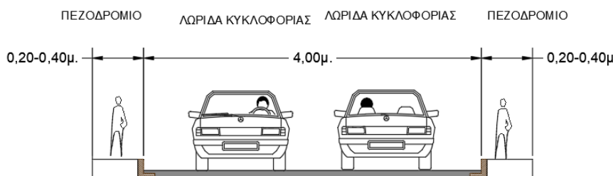
Εικόνα 1.16: Υφιστάμενη Κατάσταση οδού Βελισσαρίου
