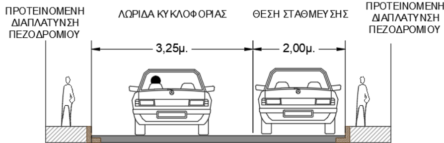
Εικόνα 1.13:Προτεινόμενη Διατομή οδού Κοραή
