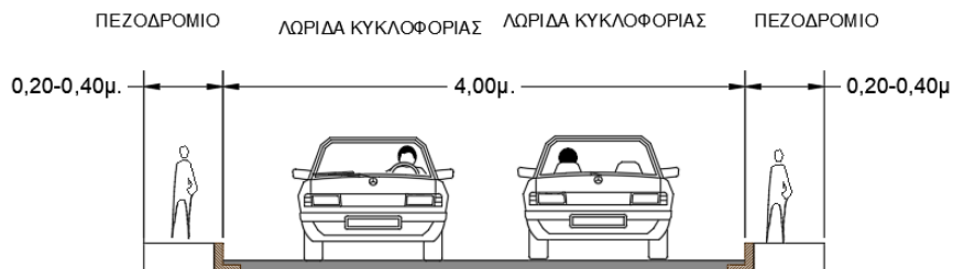
Εικόνα 1.16: Υφιστάμενη Κατάσταση οδού Βελισσαρίου
