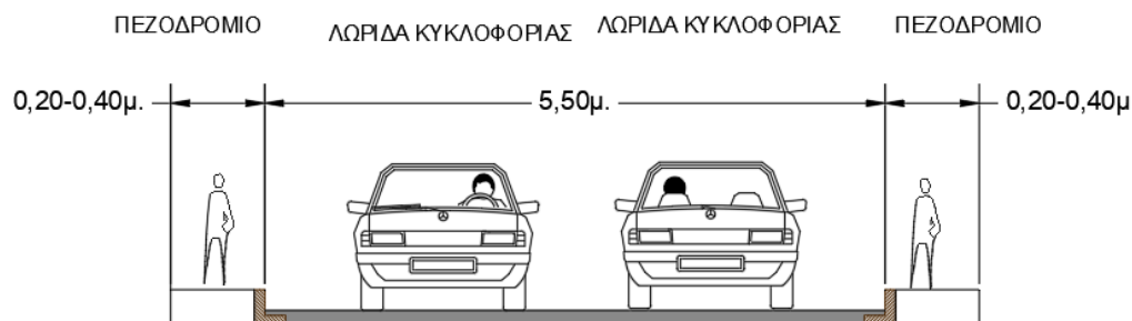
Εικόνα 1.12: Υφιστάμενη Κατάσταση οδού Κοραή
