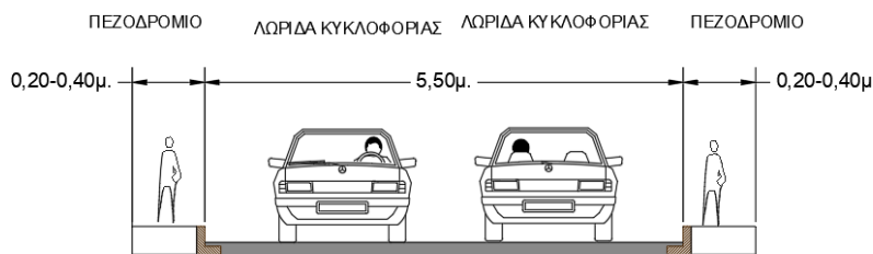
Εικόνα 1.14: Υφιστάμενη Κατάσταση οδού Βοσπόρου
