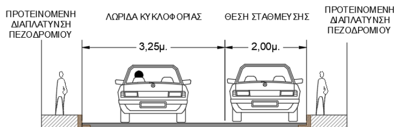
Εικόνα 1.15:Προτεινόμενη Διατομή οδού Βοσπόρου
