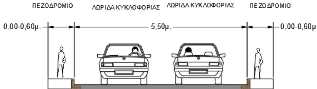
Εικόνα 6.10: Υφιστάμενη Κατάσταση οδού Νίκης
