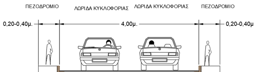
Εικόνα 1.16: Υφιστάμενη Κατάσταση οδού Βελισσαρίου
