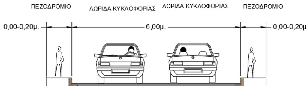
Εικόνα 4.11: Υφιστάμενη κατάσταση στην οδό Αντίπαξων
