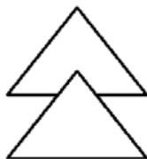
Σχήμα 5 : Εικονόσημο προστασίας από μηχανικούς κινδύνους και θερμότητα για τα γάντια συγκολλητών (είδος No 7).
