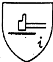
Σχήμα 5 : Εικονόσημο προστασίας από μηχανικούς κινδύνους και θερμότητα για τα γάντια συγκολλητών (είδος No 7).
