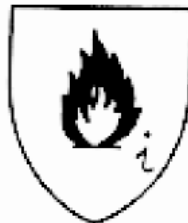
Σχήμα 5 : Εικονόσημο προστασίας από μηχανικούς κινδύνους και θερμότητα για τα γάντια συγκολλητών (είδος No 7).
