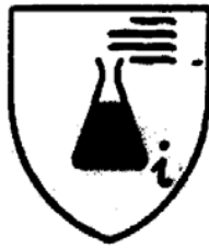
Σχήμα 3 : Εικονόσημο προστασίας από μηχανικούς κινδύνους, χημικές ουσίες και μικροοργανισμούς για τα γάντια από νιτρίλιο (είδος No 4)
